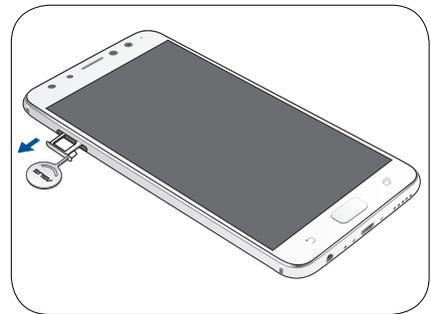
3. 將 MicroSD 記憶卡安裝至 Nano SIM 卡 2 / MicroSD 記憶卡插槽內。
