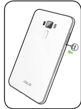
3. Keluarkan kartu Micro SD dari slot kartu combol Micro SIM/ Micro SD.
