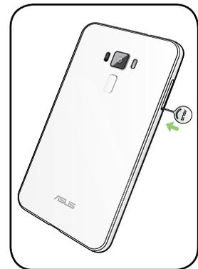
3. Keluarkan kartu Micro SIM / Nano SIM dari slot kartu combol Micro SIM, Nano SIM / Micro SD.
