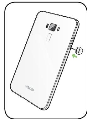
3. Masukkan kartu Micro SIM/Nano SIM atau kartu MicroSD ke dalam slot kartu.
