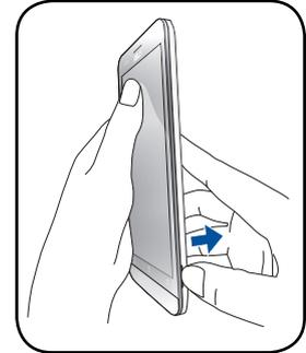
3. Désengagez lentement le couvercle arrière de la coque de l'appareil.
