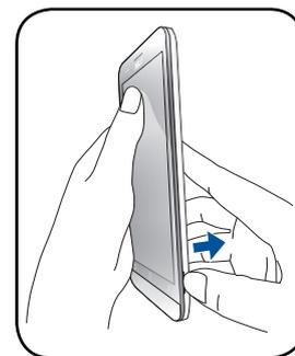
3. Désengagez lentement le couvercle arrière de la coque de l'appareil.
