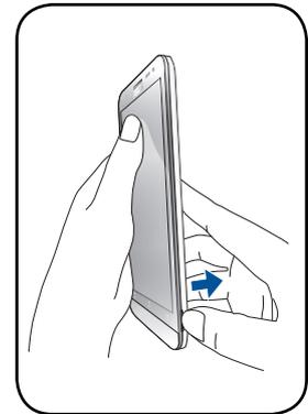
3. Désengagez lentement le couvercle arrière de la coque de l'appareil.
