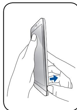
3. Désengagez lentement le couvercle arrière de la coque de l'appareil.
