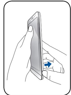
3. 溝を利用して、バックパネルカバーを取り外します。
