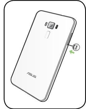
3. Entfernen Sie die Nano-SIM-Karte aus dem Nano-SIM- / microSD-Kombi-Kartensteckplatz.
