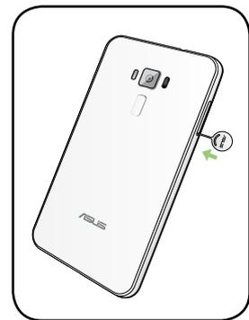
3. Masukkan kartu Nano SIM ke slot kartu kombo Nano SIM/MicroSD.
