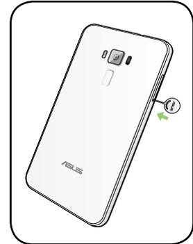
3. Keluarkan kartu micro-SIM dari slot kartu micro-SIM.
