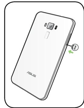
3. Keluarkan kartu MicroSD dari slot kartu kombo Nano SIM/MicroSD.
