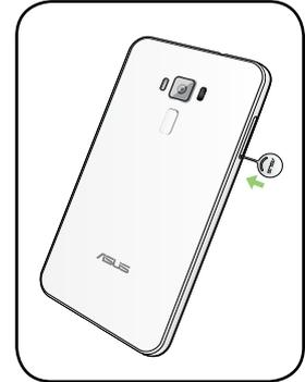
3. Keluarkan kartu Nano SIM dari slot kartu kombo Nano SIM/MicroSD.
