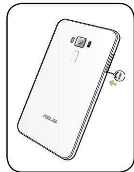
3. Masukkan kartu MicroSD ke slot kartu kombo Nano SIM/MicroSD.
