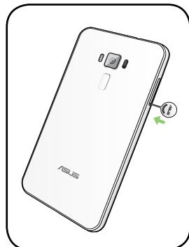
3. 対応カードスロットにmicroSIMカードまたはnanoSIMカードを挿入します。
