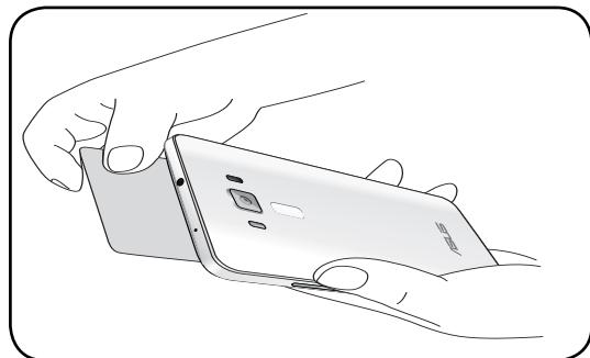
**カードエミュレーションモード:** 非接触型カードのように本機を使用することができます。
