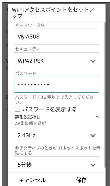
4. テザリング画面で「ポータブルWi-Fiアクセスポイント」を「ON」にします。
