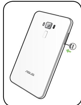
3. コンボカードスロットからmicroSIM / nanoSIMカードを取り外します。
