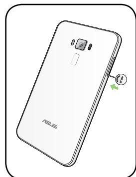
3. nanoSIM/microSDコンボカードスロットからmicroSDカードを取り外します。
