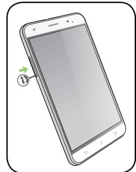
3. Inserte la tarjeta micro-SIM o nano-SIM en las ranuras para tarjetas micro-SIM o nano-SIM.
