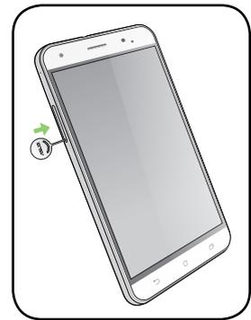
3. Inserte la tarjeta micro-SD en la ranura para tarjetas combinadas nano-SIM y microSD.
