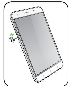
3. Quite la tarjeta micro-SIM o nano-SIM de la ranura para tarjetas combinada micro-SIM, nano-SIM y microSD.
