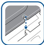
重要！请确保处理器上的缺口正确对齐到处理器插槽中的卡扣，同时处理器上的三角形标志与插槽上的三角形标志对齐。
