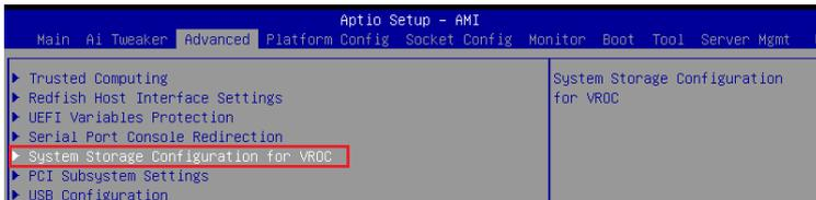
4. RAIDアレイを構成するストレージデバイスが取り付けられているM.2 Socket 3スロットまたはSlimSASポートを **[Enabled]** に設定します。
