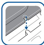
**IMPORTANT!** Asegúrese de que las muescas de la CPU están correctamente alineadas con las lengüetas del zócalo de la CPU y de que la marca triangular de dicha CPU está alineada con la misma esquina que la marca triangular del zócalo.
