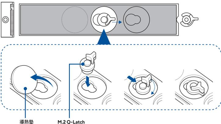
4. (選擇性)當安裝單面 M.2 模組時，請由 2242 或 2260 M.2 長度的螺絲孔上移除導熱墊，並安裝隨附的 M.2 背板橡膠軟墊。若安裝雙面 M.2 模組時，請勿安裝 M.2 背板橡膠軟墊。
