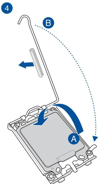
**小心！**在將拉桿固定在卡榫下之前，請確認移除拉桿上的保護軟管，否則可能會在安裝冷卻系統時損壞您的系統。
