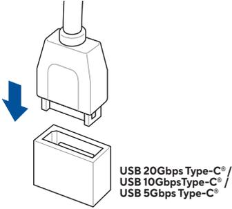
小心！本插槽僅能以一個方向插入。請將插頭壓入插槽直到卡入定位。
