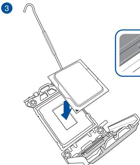
**重要！**請確保處理器上的缺口正確對齊到處理器插槽中的卡榫，同時處理器上的三角形標誌與插槽上的三角形標誌對齊。
