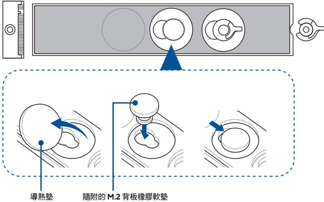
5. 旋轉並調整 M.2 Q-Latch，使手柄遠離 M.2 插槽。
