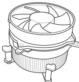
3. 依照中央處理器散熱風扇廠商的建議或指示，清潔該元件以避免因灰塵或異物導致風扇轉速過低或處理器過熱的狀況。
