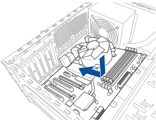
3. 將隨附的螺絲放入主機板上的螺絲孔並旋轉鎖緊，以確保將主機板鎖至機殼。
