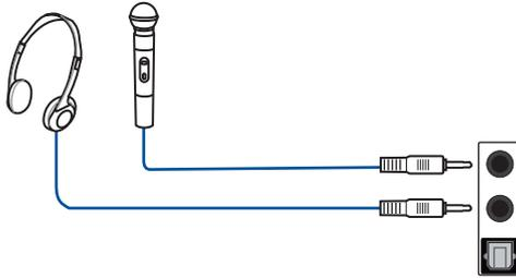
說明：音訊輸出接頭不支援空間音效功能。想要使用空間音效功能時，請將音訊輸出裝置連接至前面板的音訊接頭，或使用 USB 介面音效裝置。
