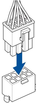
6-pin PCIe 顯示卡插座
