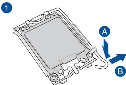
小心！抬起負載桿時要小心，請確認在釋放負載桿時抓住負載桿。立刻鬆開負載桿可能會導致其彈回並損壞主機板。
