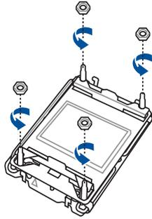
小心！請將拆下的螺帽妥善保管，避免隨意放置或掉落在主機板上，否則可能會損壞您的主機板。
