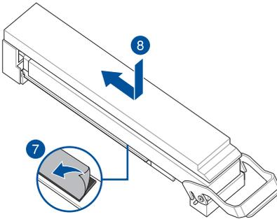
9. 扣回卡榫以固定散熱器。
