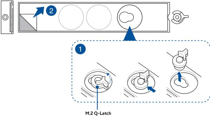
3. (選擇性) 請由要安裝 M.2 長度的螺絲孔上移除導熱墊，並安裝隨附的 M.2 Q-Latch。
