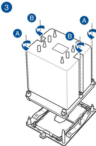
**重要！** 處理器與散熱片元件只能以一個方向正確安裝。請勿強制將處理器與散熱片元件裝入插槽，以避免弄彎處理器的針腳或損壞插槽。
