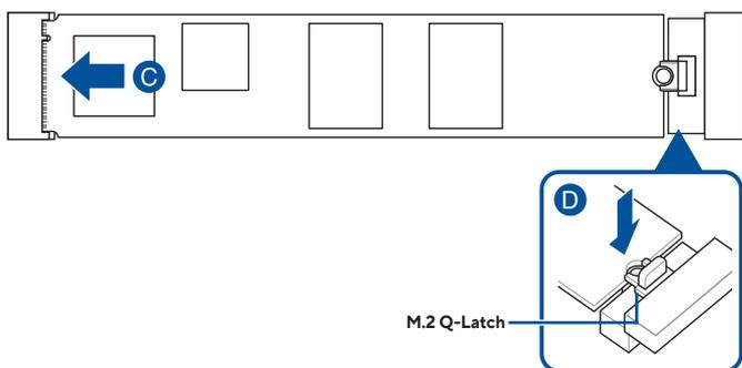
**安裝 2280/2260/2242 M.2 模組至 22110 長度的 M.2 插槽（含背板），或安裝 2260/2242 M.2 模組至 2280 長度的 M.2 插槽（含背板）**
