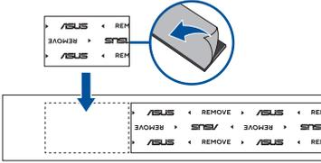
7. 從散熱器底部的導熱墊上移除塑膠膜。
