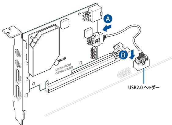
5. 電源ユニットの6ピン PCIe 電源ケーブルを、USB4 PCIE GEN4 CARDの6ピン PCIe 電源コネクターに接続します。
