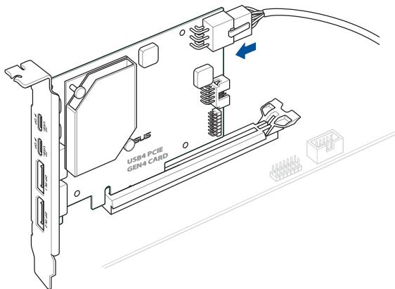
6. (オプション) 映像出力をする場合は、同梱のDisplayPortケーブルを使用して、USB4 PCIE GEN4 CARD のDisplayPort入力ポート (DP IN 1 / DP IN 2) とマザーボードまたはグラフィックスカードのDisplayPort出力ポートを接続します。
