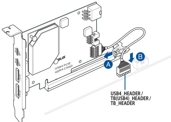
4. 同梱の10-1ピン USB 2.0 ヘッダー ケーブルを使用して、USB4 PCIE GEN4 CARDの10-1ピン USB 2.0 ヘッダーとマザーボードのUSB 2.0 ヘッダーを接続します。
