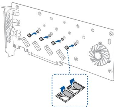
3. 取り付ける M.2 SSD のタイプを確認し、適切な位置にスペーサーを取り付けます。
