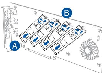
5. 將散熱片的膠膜撕開，用先前移除的上蓋螺絲將上蓋固定至華碩 HYPER M.2 X16 GEN 4 卡，接著將華碩 HYPER M.2 X16 GEN 4 卡安裝至 PCI Express 4.0/3.0 插槽。
