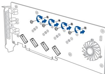
4. 將 M.2 儲存裝置插入 PCIe M.2 儲存裝置連接埠 (A)，然後再將產品隨附的螺絲固定 M.2 儲存裝置 (B)。
