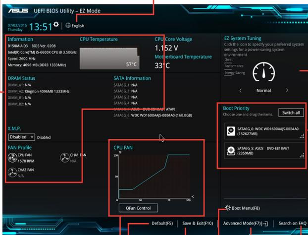
Affiche la vitesse du ventilateur de processeur. Appuyez sur ce bouton pour régler les ventilateurs manuellement
