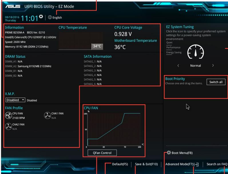
Affiche la vitesse du ventilateur du processeur. Appuyez sur ce bouton pour régler les ventilateurs manuellement
