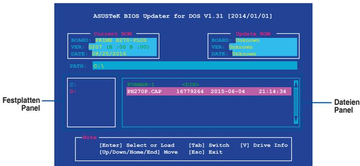
3. Drücken Sie die Taste <Tab>, um zwischen den Feldern zu wechseln und wählen Sie die BIOS-Datei mit den <Bild auf/Bild ab/Pos 1/Ende>-Tasten; anschließend drücken Sie die <Eingabetaste>.
