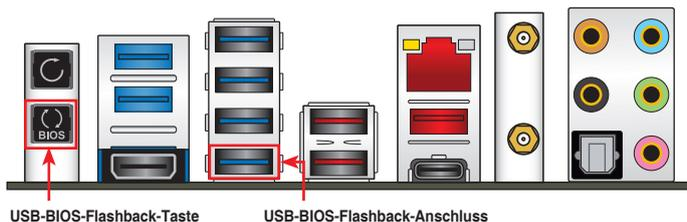
6. Warten Sie bis das Licht ausgeht, was bedeutet, dass die Aktualisierung des BIOS beendet ist.
