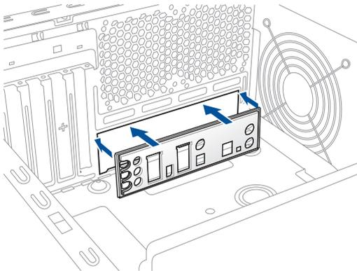
2. Installieren Sie das Motherboard in das Gehäuse. Achten Sie hierbei darauf, dass die hinteren E/A-Anschlüsse genau auf die E/A-Blende in der Gehäuserückwand ausgerichtet sind.
