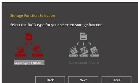
5. Nach der Auswahl des RAID-Typs, klicken Sie auf **Weiter** und dann auf **Ja**, um mit dem RAID Setup fortzufahren.
