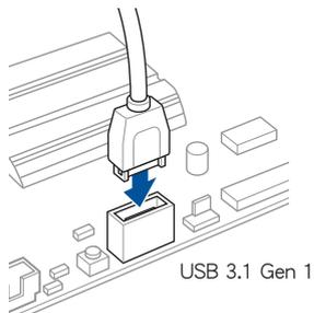
安装 USB 3.1 Gen 1 连接插槽
