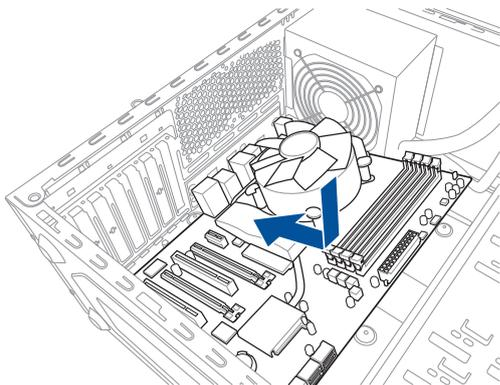
2. 下図を参考に、取り付けのネジをすべて仮止めし、対角線上に少しずつ締めていきます。
