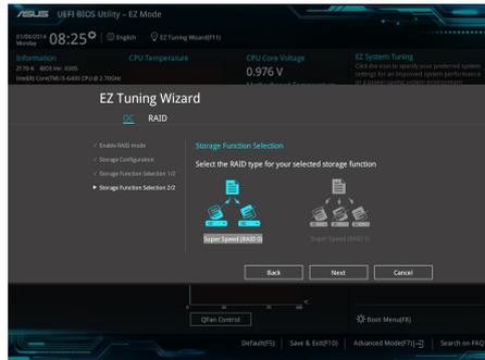
4. Nach der Auswahl des RAID-Typs, klicken Sie auf **Weiter** und dann auf **Ja**, um mit dem RAID Setup fortzufahren.
