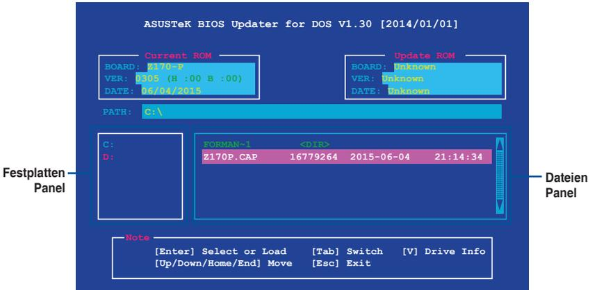
3. Drücken Sie die Taste <Tab>, um zwischen den Feldern zu wechseln und wählen Sie die BIOS-Datei mit den <Bild auf/Bild ab/Pos 1/Ende>-Tasten; anschließend drücken Sie die <Eingabetaste>.
