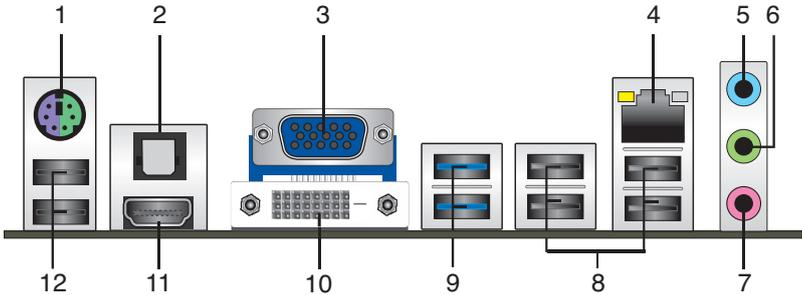
1. PS/2 滑鼠/鍵盤兩用連接埠：將 PS/2 滑鼠/鍵盤插頭連接到此連接埠。
