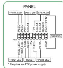
Dieser 2-polige Header ist für die Festplattenaktivitäts-LED. Verbinden Sie das Kabel der Festplattenaktivitäts-LED mit diesem Header. Die Festplatten-LED leuchtet auf oder blinkt, wenn Daten gelesen oder auf die Festplatte geschrieben werden.
