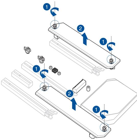
3. M.2 Socket 3 スロットにM.2 SSDを取り付けます。長さの異なるM.2 SSDを取り付ける場合は、手順が異なる場合があります。各タイプの取り付け手順を参考に作業を行ってください。
