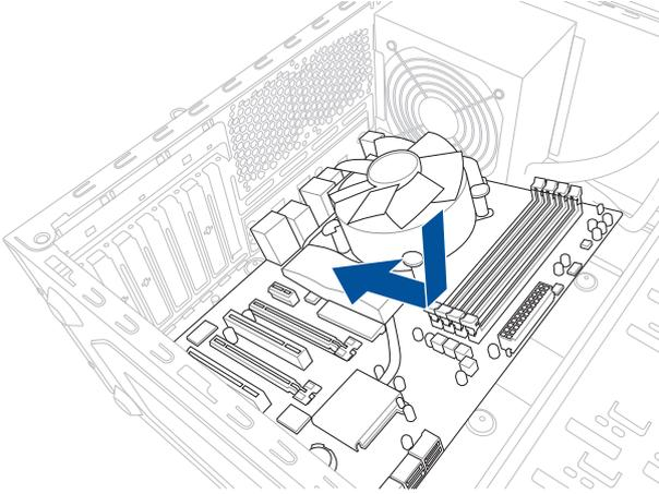
2. 下図を参考に、取り付けネジをすべて仮止めし、対角線上に少しずつ締めていきます。
