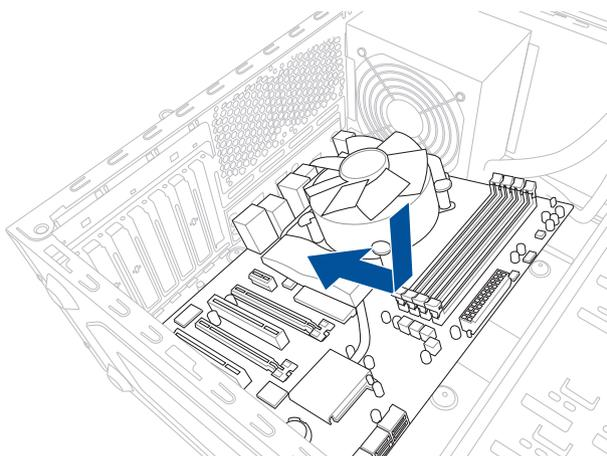
3. Placez six (6) vis dans les pas de vis (marqués d'un cercle rouge sur l'illustration ci-dessous) pour sécuriser la carte mère au châssis.
