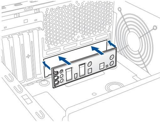
2. Placez la carte mère dans le châssis en vous assurant que ses ports d'E/S (entrée/sortie) sont alignés avec la zone d'E/S du châssis.
