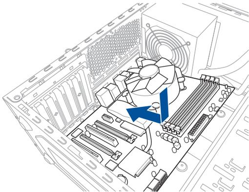
3. Placez huit (8) vis dans les pas de vis (marqués d'un cercle rouge sur l'illustration ci-dessous) pour sécuriser la carte mère au châssis.
