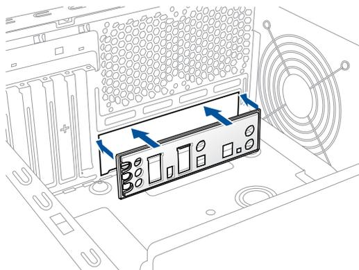
2. 将主板放入机箱，并确认后侧 I/O 接口对齐机箱的后侧 I/O 面板。
