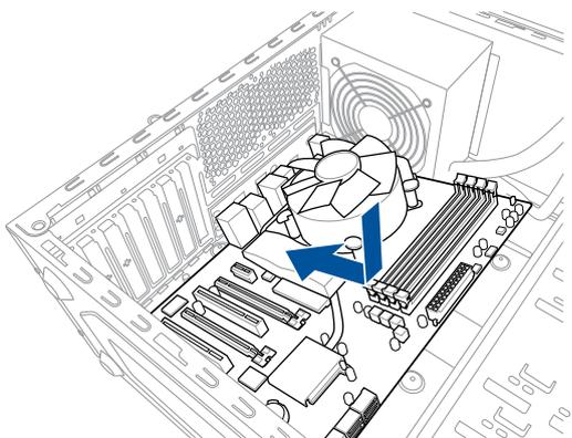
3. 请将下图所圈选出来的“九”个螺丝孔位对准主机机箱内相对位置的螺丝孔，接着再一一锁上螺丝固定主板。
