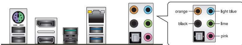
**Anschluss eines Kopfhörers und Mikrofons**
