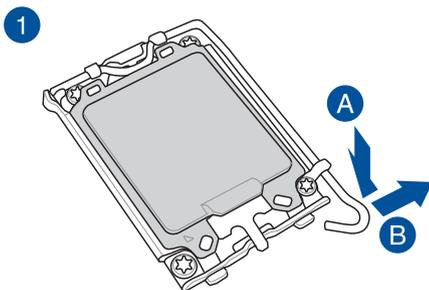
Seien Sie vorsichtig beim Anheben des Befestigungshebels. Achten Sie darauf, den Befestigungshebel beim Lösen noch festzuhalten. Ein Loslassen des Befestigungshebels unmittelbar nach dem Lösen kann dazu führen, dass der Befestigungshebel zurückfedert und Ihr Motherboard beschädigt wird.
