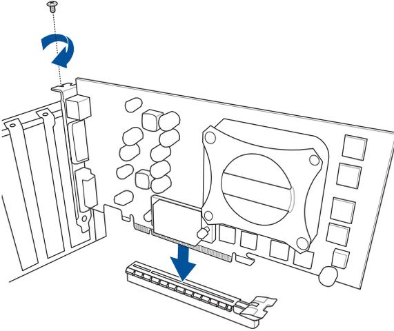
So installieren Sie eine PCIE x1 Karte
