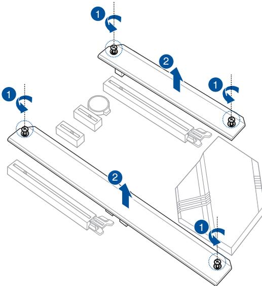
3. Installieren Sie Ihr M.2 in Ihrem M.2 Steckplatz. Die Schritte können bei der Installation von M.2 verschiedener Länge unterschiedlich sein. Bitte geben Sie auf die verschiedenen Typen und deren Installationsschritte unten acht:
