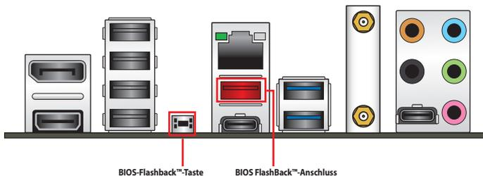
6. Warten Sie bis das Licht ausgeht, was bedeutet, dass die Aktualisierung des BIOS beendet ist.
