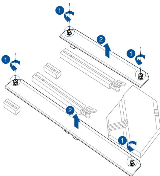
3. Installez votre module M.2 dans le slot M.2. Les étapes d'installation peuvent différer selon la longueur du module M.2, référez-vous aux procédures d'installation adaptées aux différents types de lecteurs M.2 :
