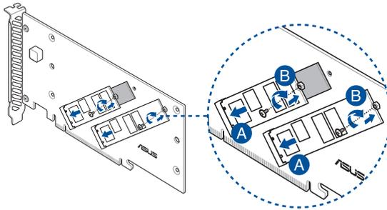
5. Ziehen Sie die Schutzfolie von den Wärmeleitpads ab (A) und befestigen Sie die Abdeckung mit den zuvor entfernten Schrauben an der ROG HYPER M.2-Karte (B). Installieren Sie dann die Karte in einen PCIe Steckplatz (C).
