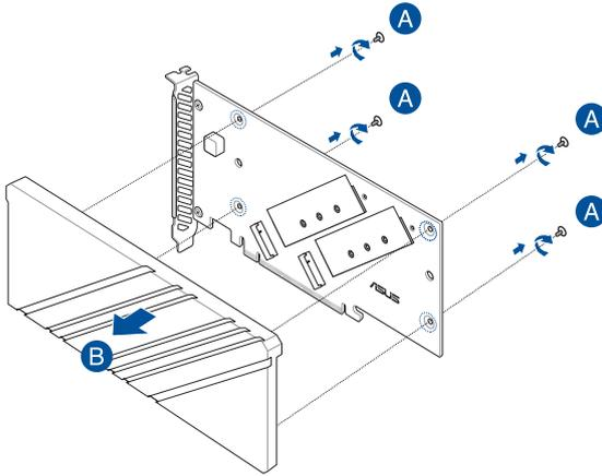
2. Ziehen Sie die Schutzfolie von den Wärmeleitpads an den M.2 Steckplätzen ab.
