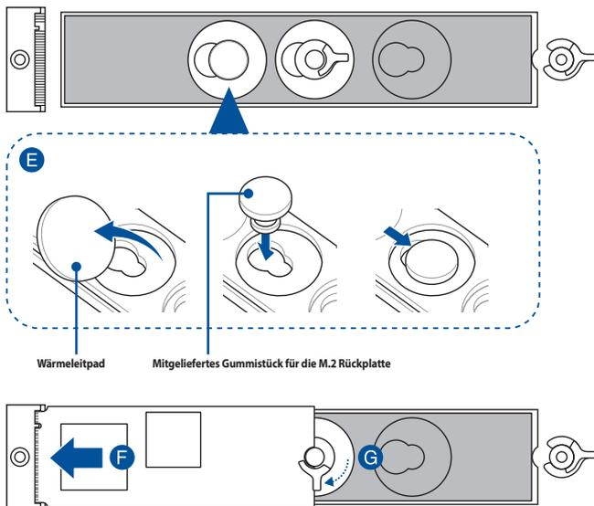
• **So installieren Sie ein M.2 im M.2\_2- und M.2\_3-Steckplatz**
