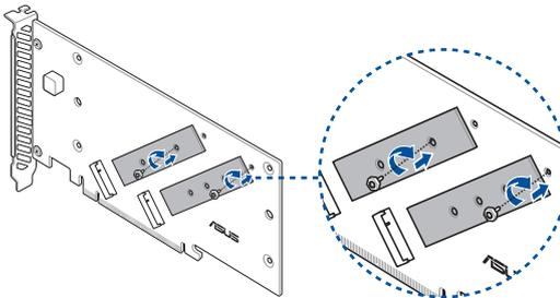
4. Installieren Sie die M.2 Speichergeräte in den integrierten M.2 Steckplätzen (A), befestigen Sie dann die M.2 Speichergeräte mit den mitgelieferten Schrauben (B).
