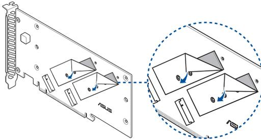
3. Befestigen Sie die Sockelschrauben an der ROG HYPER M.2-Karte.
