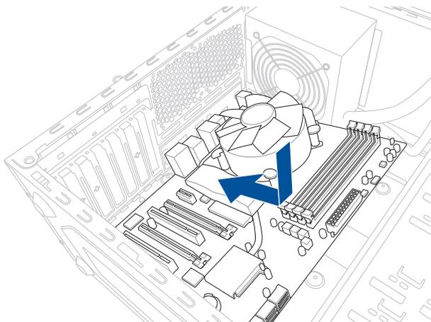
2. Placez sept (7) vis dans les pas de vis (marqués d'un cercle rouge sur l'illustration ci-dessous) pour sécuriser la carte mère au châssis.
