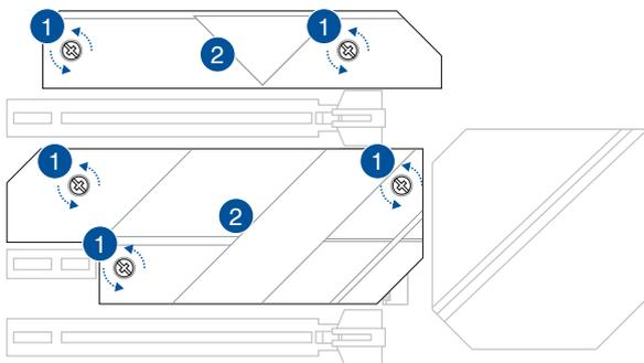
3. Installez votre module M.2 dans le slot M.2. Les étapes d'installation peuvent différer selon la longueur du module M.2, référez-vous aux procédures d'installation adaptées aux différents types de lecteurs M.2 :
