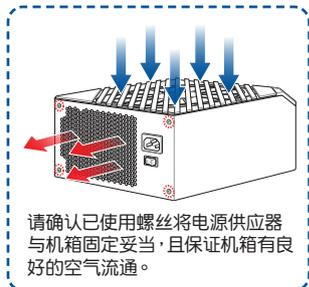
请确认已使用螺丝将电源供应器与机箱固定妥当，且保证机箱有良好的空气流通。
