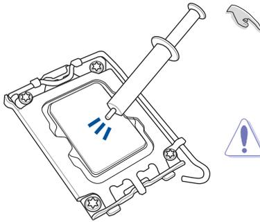
CPUクーラーを取り付ける前に、必ずCPUにサーマルグリスを塗布してください。CPUクーラーには、サーマルグリスや熱伝導体シートなどが購入時から塗付されているモデルもあります。
