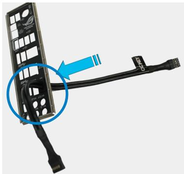
2. Stecken Sie das OC Key-Kabel in den Onboard-Anschluss der mit **OC Key** beschriftet ist.
