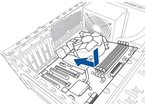
3. Placez 9 vis dans les pas de vis (marqués d'un cercle rouge sur l'illustration de bas de page) pour sécuriser la carte mère au châssis d'ordinateur.
