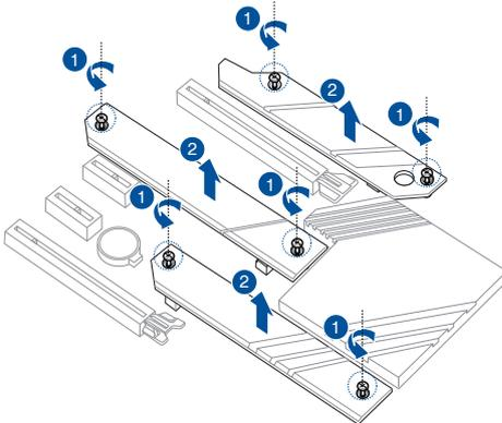
3. Installieren Sie Ihr M.2 in Ihrem M.2 Steckplatz. Die Schritte können bei der Installation von M.2 verschiedener Länge unterschiedlich sein. Bitte geben Sie auf die verschiedenen Typen und deren Installationsschritte unten acht:
