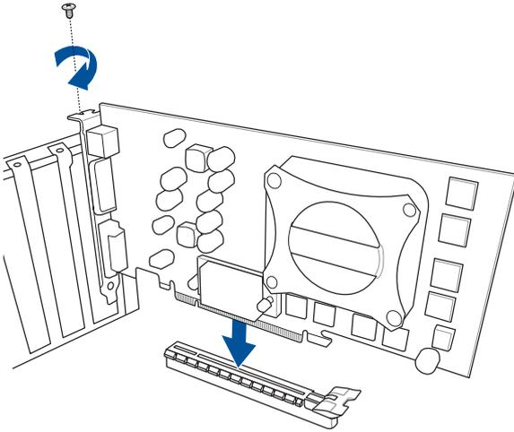
So installieren Sie eine PCIE x1 Karte
