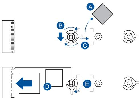
4. Entfernen Sie die Schutzfolie vom Wärmeleitpad auf der Unterseite des Kühlkörpers.
