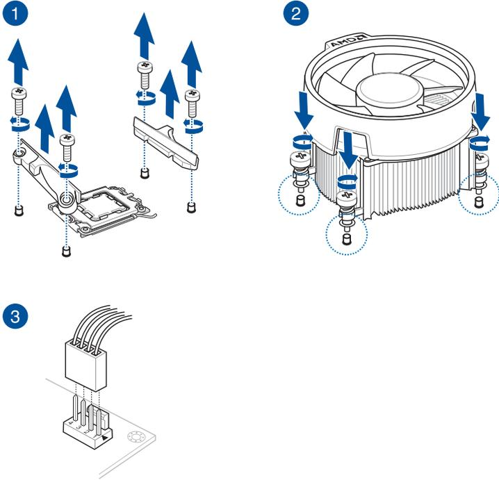
Bei Verwendung dieses CPU-Lüfertyps entfernen Sie nur die Schrauben und das Feststellbauteil. Entfernen Sie nicht die Platte auf der Unterseite.
