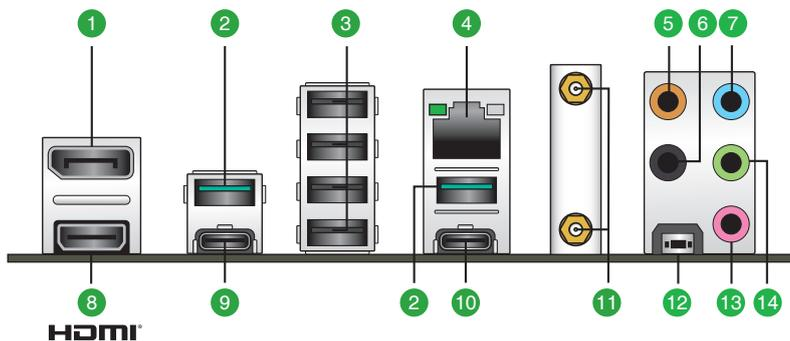
1. **DisplayPort-Anschluss.** Dieser Anschluss ist für DisplayPort-kompatible Geräte.
