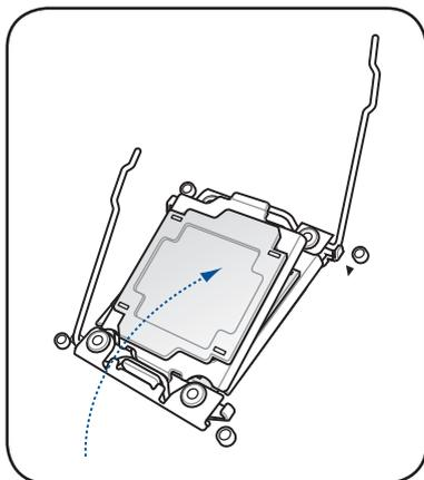
10. 推下右侧固定扳手 (I)，确保安装盒上盖的边缘被扳手固定 (J)。然后将右侧固定扳手插入固定扣下。
