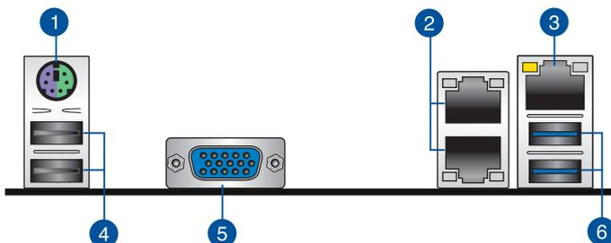
1. PS/2 键盘/鼠标接口（紫色/绿色）：将 PS/2 键盘/鼠标插头连接到此端口。
