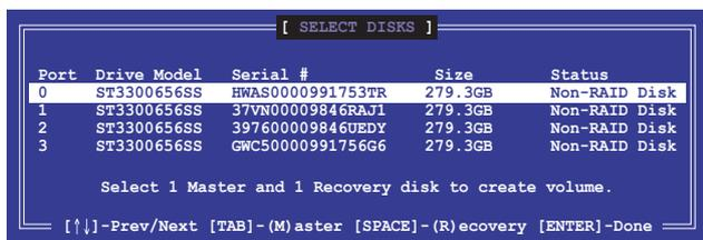
5. 请使用向上、向下方向键来选择硬盘设备，确认后请按下空格键来进行选择。接着被选定的硬盘设备旁便会出现一个小三角形图标。当所有要进行阵列设置的硬盘设备选择完毕后，请按下 <Enter> 键。
