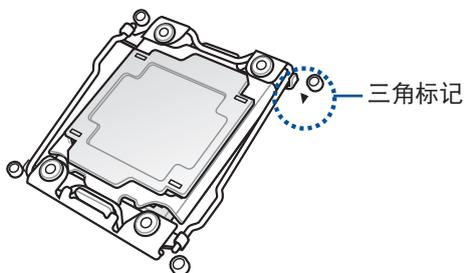
2. 用姆指按下左侧固定扳手（A）并将其稍向右侧推（B），直到扳手脱离固定扣并轻轻抬起固定扳手（C）。
