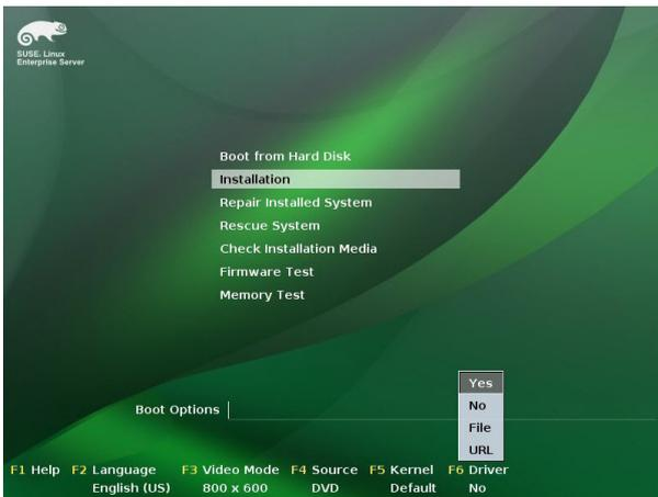
4. 将 RAID 驱动程序软盘放入软驱。在【Boot Options】（启动选项）后输入命令行：**brokenmodules=ahci**，然后按下 <Enter> 键。
