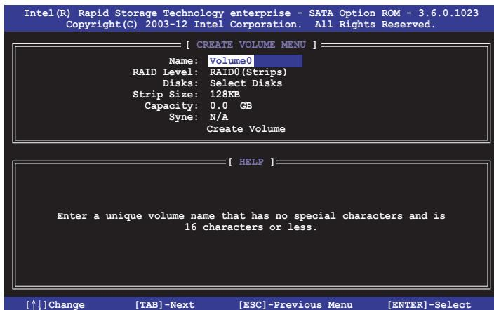
3. 選擇 RAID 層級 (RAID Level)，使用向上/向下方向鍵來選擇您欲建立的 RAID 層級，然後按下 <Enter> 鍵。
