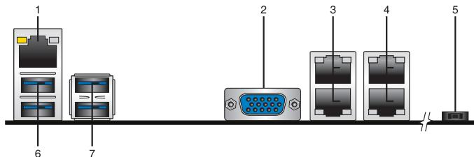
1. RJ-45 網路埠：用於 iKVM，只有開啟 ASMB9 控制器時，此埠才有作用。
