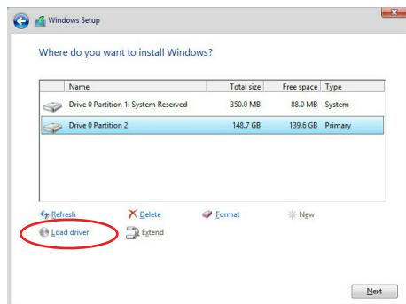
4. 訊息欄跳出，提醒插入含有 RAID 驅動程式的安裝媒體。若您的系統中僅有一個光碟機，請先取出 Windows 作業系統安裝光碟，並置換為主機板驅動程式與公用程式光碟。點選 **Browse** 以繼續。
