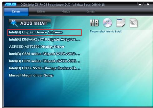
4. 接著顯示 Intel® Chipset Device Software 畫面，請依照畫面的指示按 **Next** 進行安裝。
