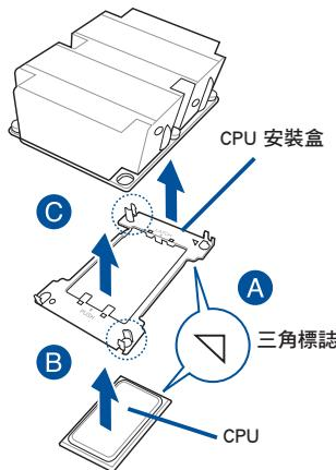
4. 將 CPU 及 CPU 安裝盒對齊，將散熱器放置在已安裝好的 CPU 上方。
