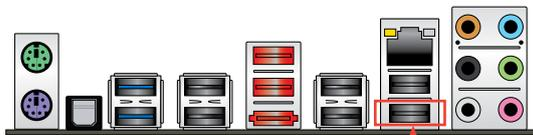
Dieser USB-Port kann zur Unterstützung von USB-BIOS-Flashback (USB-BIOS-Flashback-Port) umgeschaltet werden.
