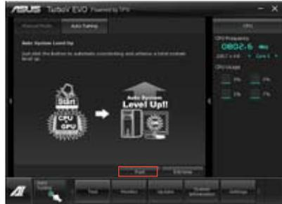
3. TurboV übertaktet automatisch die CPU, speichert die BIOS-Einstellungen und startet das System neu. Nachdem Sie Windows wieder betreten, informiert Sie eine Nachricht über den Erfolg von Auto Tuning. Zum Verlassen auf **OK** klicken.
