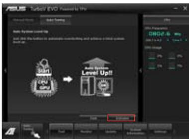
3. TurboV übertaktet automatisch die CPU und den Speicher und startet das System neu. Nachdem Sie Windows wieder betreten, informiert Sie eine Nachricht über den Ergebnisse der aktuellen Übertaktung. Klicken Sie auf **Stop**, um diese zu behalten.
