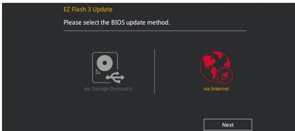
3. Drücken Sie zur Auswahl einer Internetverbindungsmethode die Links-/Rechtstaste, drücken Sie dann <Enter>.
