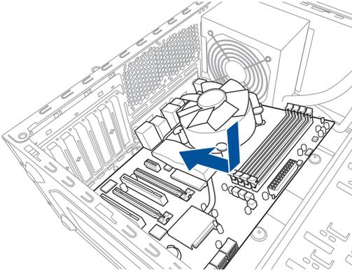
2. Setzen Sie neun (9) Schrauben in die durch Kreise markierten Bohrlöcher ein, um das Motherboard im Gehäuse zu befestigen.
