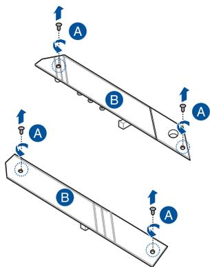
4. 下図を参考に、取り付けネジをすべて仮止めし、対角線上に少しずつ締めていきます。
