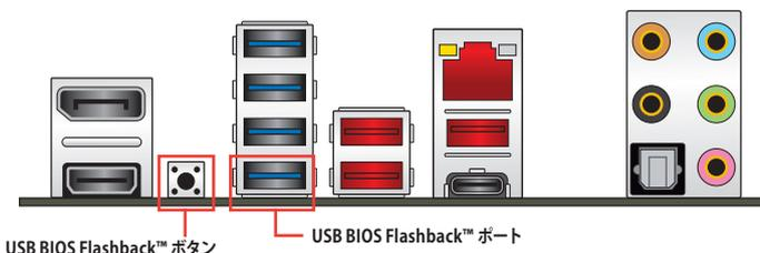
6. USB BIOS Flashback™ が完了するとLEDは消灯します。LEDが完全に消灯したことを確認してシステムを起動し、UEFI BIOS Utilityを確認します。
