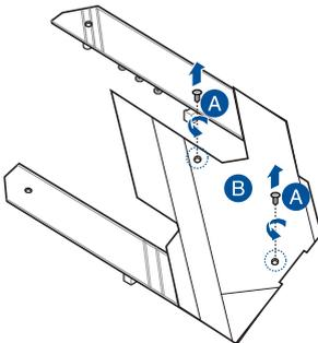
3. M.2 ヒートシンクを固定しているネジを取り外し (A)、M.2 ヒートシンクを取り外します (B)。
