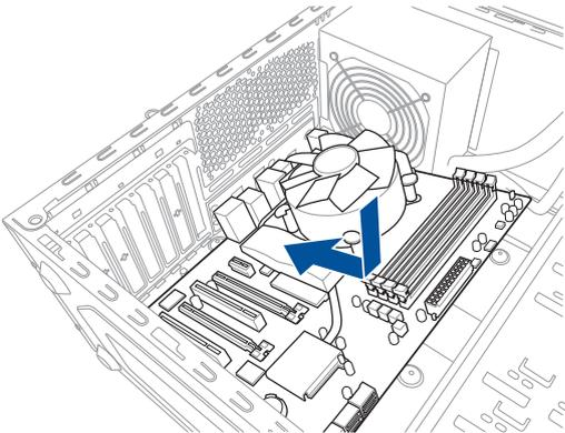
3. 下図を参考に、取り付けネジをすべて仮止めし、対角線上に少しずつ締めていきます。
